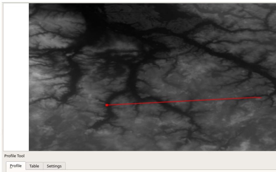
Рис. 3 – Построение 3d карты высот с помощью Qgis из данных поверхности рельефа ASTER GDEM в районе БелАЭС
